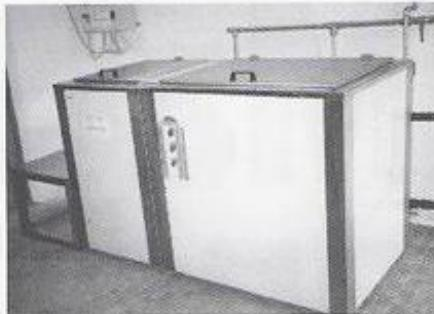
Impianto di lavaggio ultrasuoni, risciacquo ultrasuoni idrocinetico, protezione e asciugatura finale, mod. 250.
